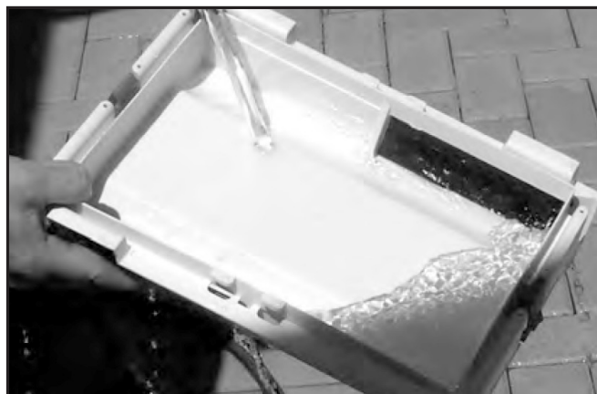
Obr. 6: Hadicí opláchněte nečistoty z dolního krytu. Vyčistěte především jemné filtry na vstupních otvorech, jak ukazuje obr. 6.
