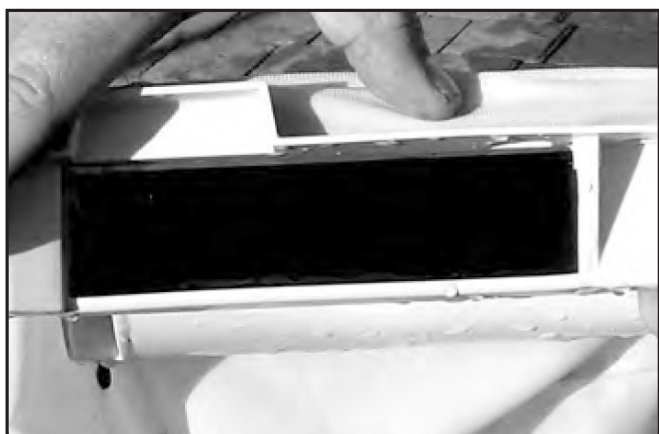
Obr. 7: Při vracení filtrovacího vaku jej nejprve protáhněte zpět. Rám filtrovacího vaku pak umístěte na dolní kryt tak, aby plně zapadl do drážky. Zkontrolujte dosednutí filtru na dolní kryt (viz obr. 7).
