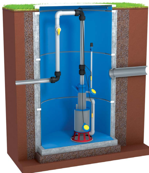
Vertikální řez přečerpávací nádrže pro tlakovou kanalizaci
