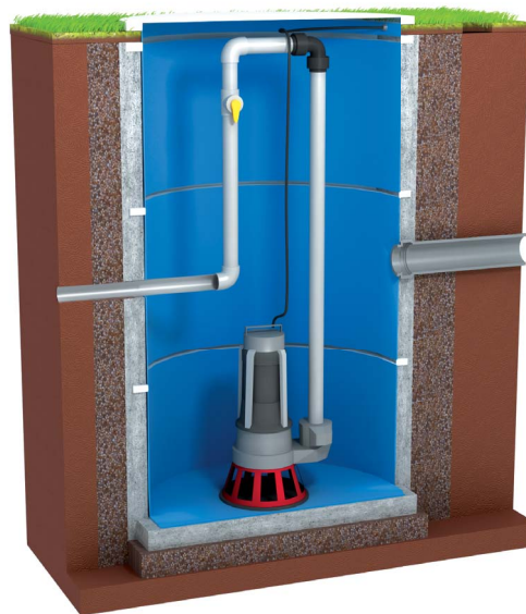
Vertikální řez přečerpávací nádrže pro gravitační kanalizaci
